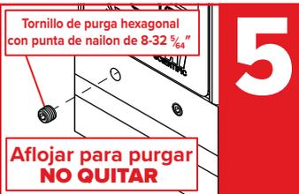
Conecte el dispositivo a su proceso e inicie el flujo de agua. Para eliminar las burbujas de aire:
