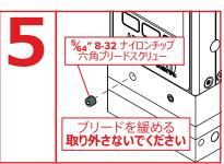
デバイスを設置し、流体を流します。 気泡を取り除く方法:
