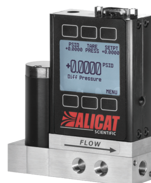
Régulateur de pression 15-PSID avec deux ports de détection de pression différentielle à l'avant et un connecteur série DB-9.
